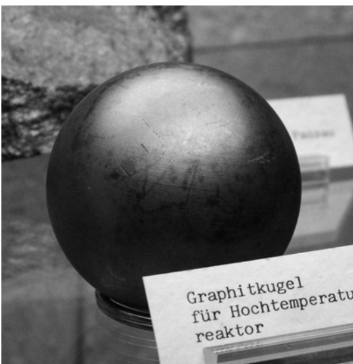
Abbildung 3: Graphitkugel für Hochtemperaturreaktor
