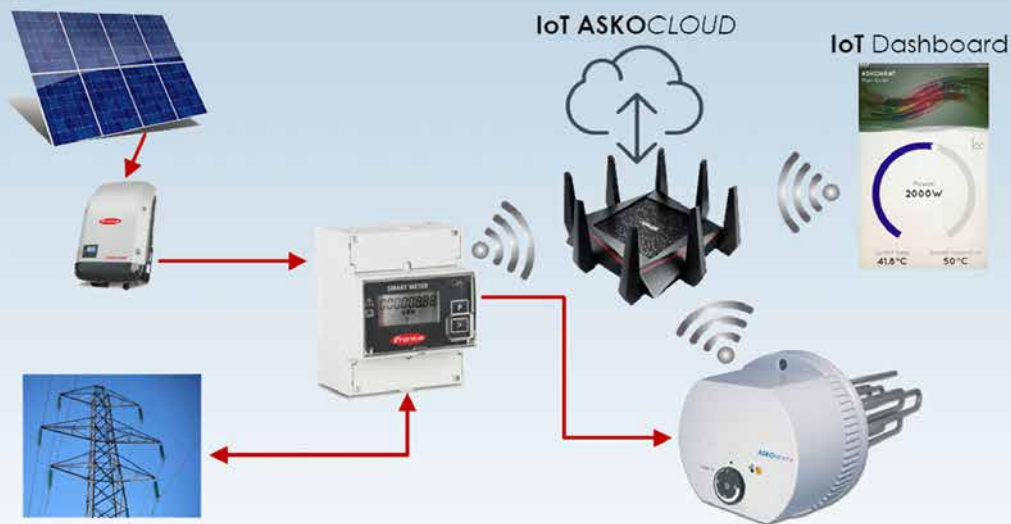
Mit ASKO CLOUD werden Heizstäbe der ASKOHEAT-Familie intelligent gesteuert und systemoffen in Smart Home-Lösungen eingebunden um PV Überschussstrom zu speichern (Foto: Askoma)
